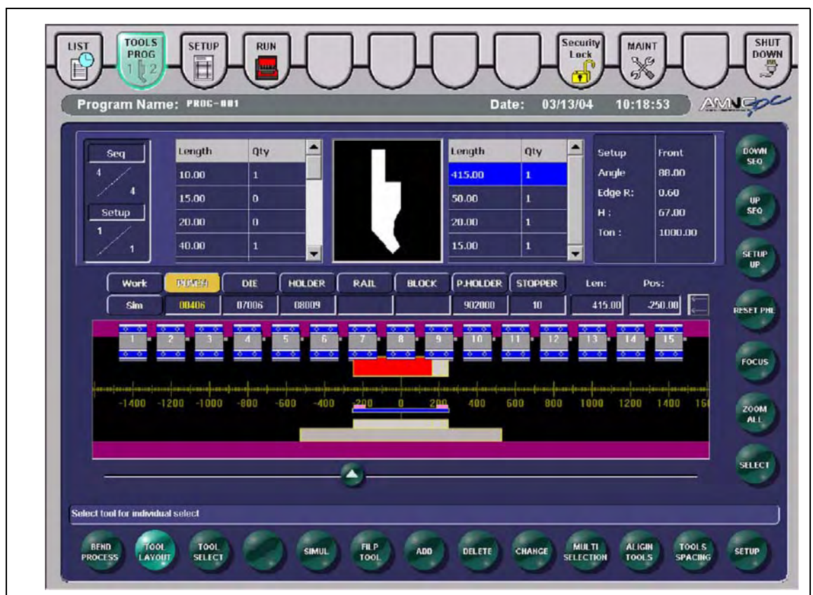
Abb. 7-87 „TOOL LAYOUT“-Display mit Standard-Werkzeuanordnung
