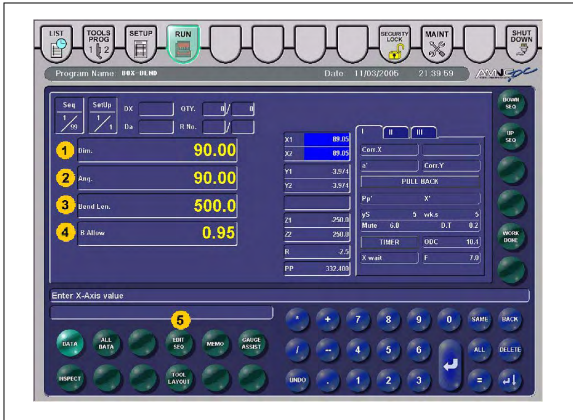
Abb. 6-86 „RUN“-Display (ANGLE- und DIRECT-Modus)
