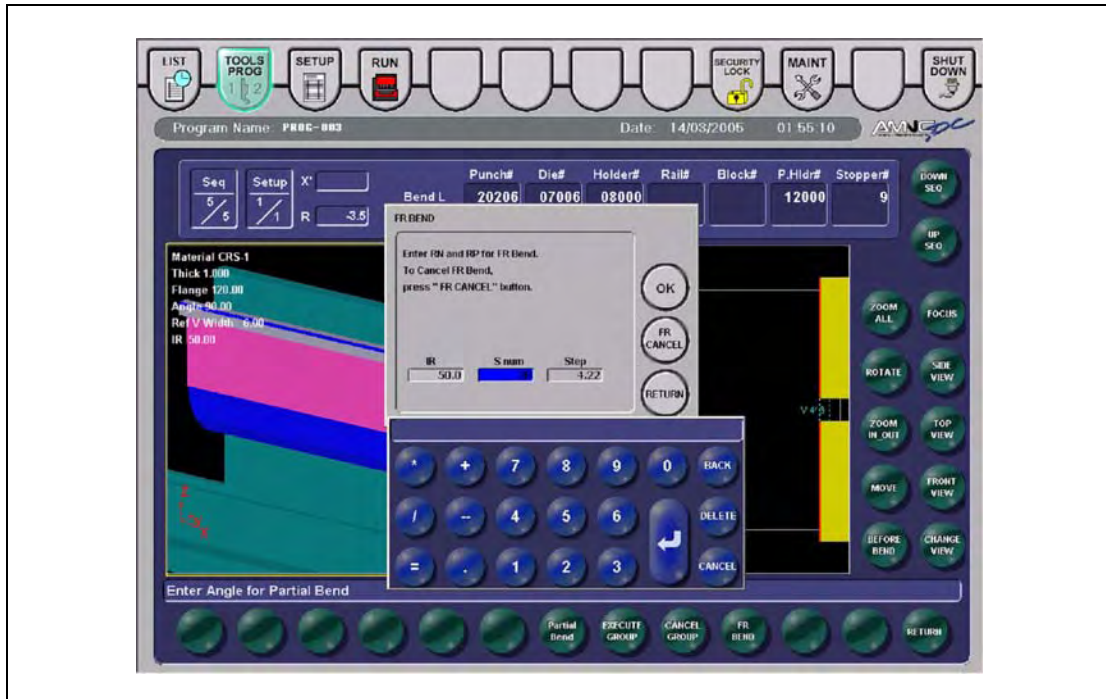
Abb. 6-29 Einstellungen für das Radiusabkanten
