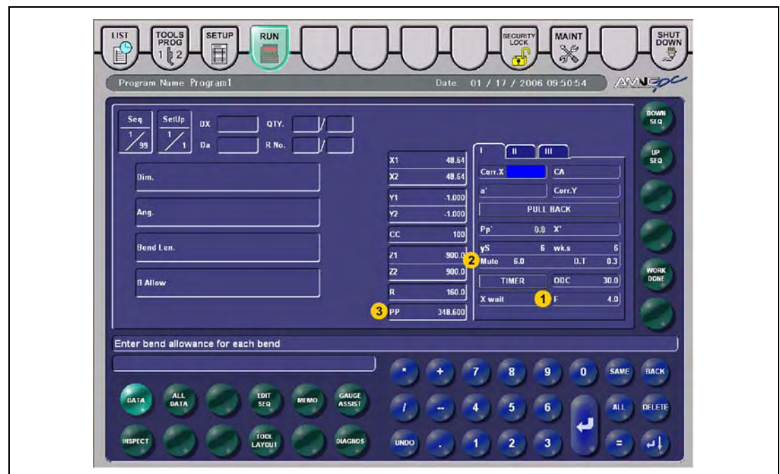
Abb. 7-86 „RUN“-Display (ANGLE- und DIRECT-Modus)
