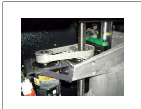
Abb. 8-14 Zahnriemen R-Achse (Hinteranschlag Typ B)
