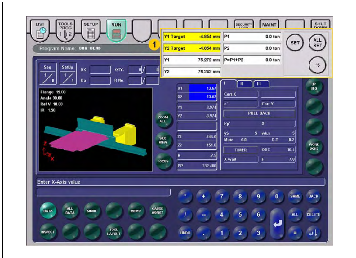
Abb. 6-96 „RUN“-Display (Kontrollleuchte der Taste „EIN“ an der Steuereinheit Fernbedienung leuchtet)
