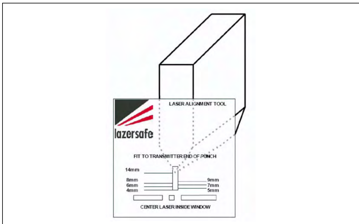
Abb. 11-9 Einstellung des Lasersenders
