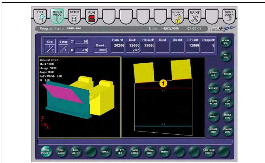
Abb. 7-55 „BEND PROCESS“-Display (3D-Modus)
